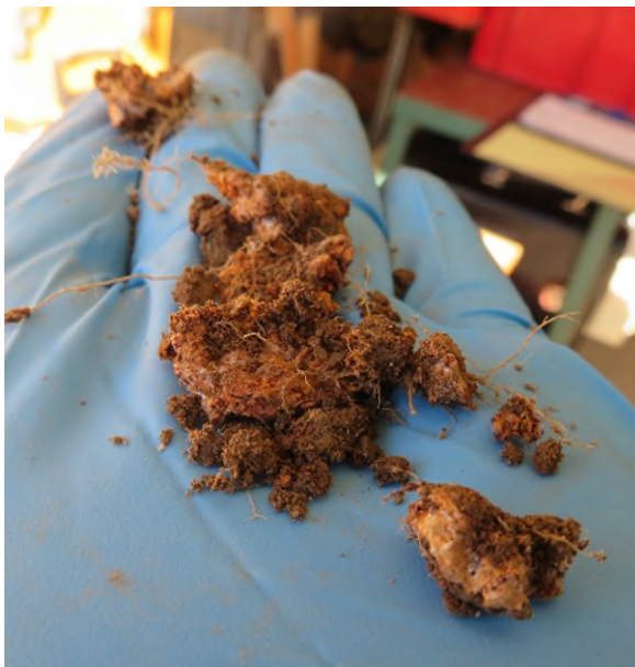
Abb. 4: nicht abgebaute Papierfasern aus dem Oberboden des Kleinlysimeters 4
