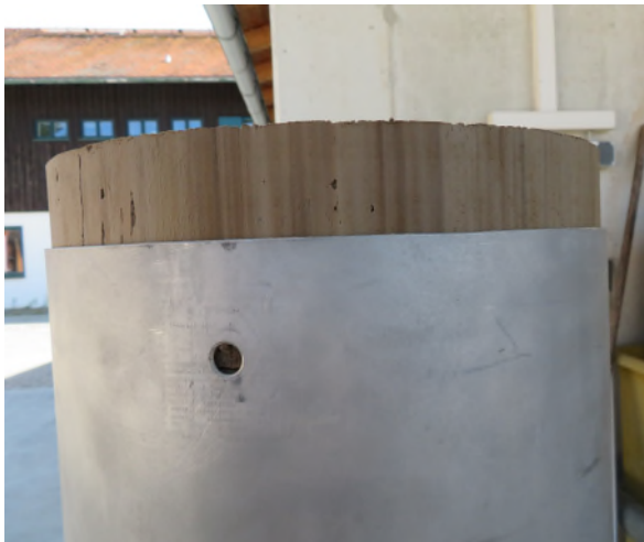
Abb. 8: Anheben des Lysimeterkerns aus dem Zylinder
