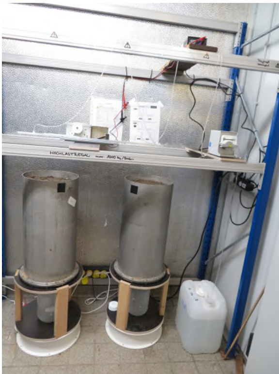
Abb. 6: Aufbau der Kleinlysimeter im Kühlraum mit Beregnungsanlage
