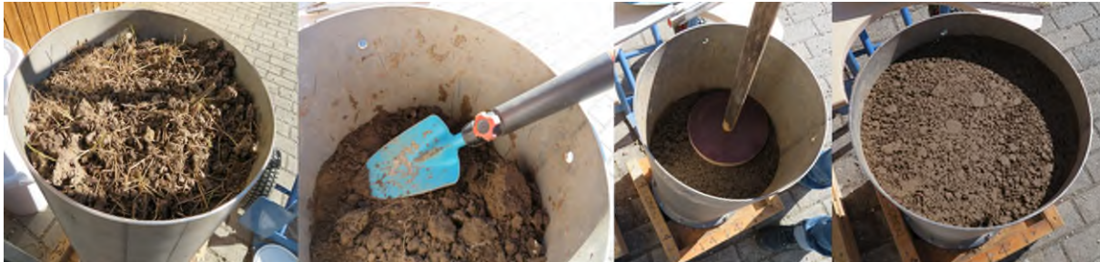
Abb. 5: Vorgang Oberbodenaustausch: Bild 1 Lysimeter vor Oberbodenentnahme, Bild 2 Entnahme des Oberbodens mittels Handschaufel, Bild 3 Verdichten des aufgegebenen Austauschbodens, Bild 4 Lysimeter nach Neubefüllung
