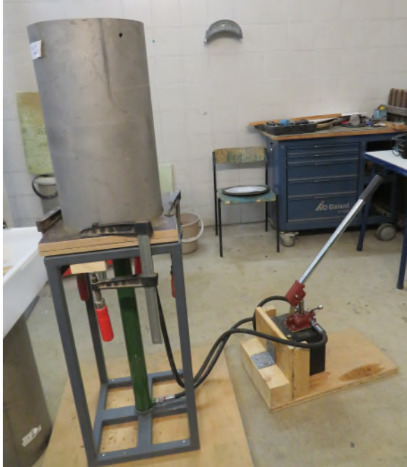
Abb. 7: Hydraulische Vorrichtung, die das Herauschieben des Bodenkerne aus den Zylindern ermöglicht
