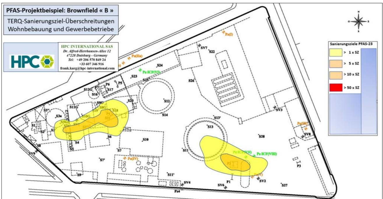
Abb. 9b: Beispiel „Mineralöl-Standort „B“: Boden-Sanierungsbedarf gemäß Sanierungsziele bei Anwendung des TERQ-Maßnahmenwerts für PFOS (Perfluorooctansulfonsäure) > 0,02 mg/l Eluat [47-50].
